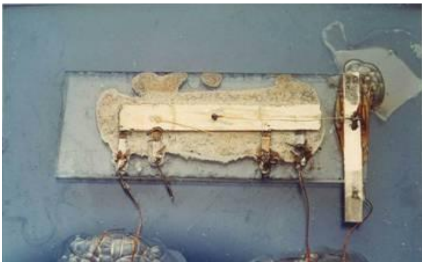
1958年8月28日世界第一块集成电路 尺寸 7/16 \times 1/16 英寸 基尔比获2000年 诺贝尔奖
