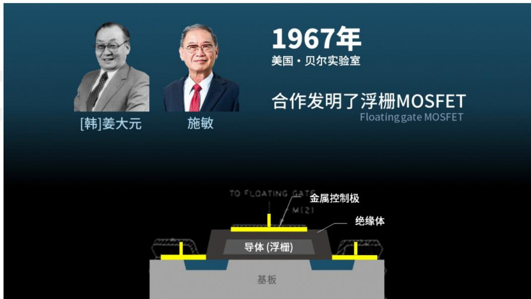
Dawon Kahng (韩) 和 Simon Sze (华裔) 在贝尔实验室发明了非易失性存储器浮动门 (Floating Gate) 本文发表为 “A Floating Gate and Its Application to Memory Devices” (贝尔系统技术期刊)
